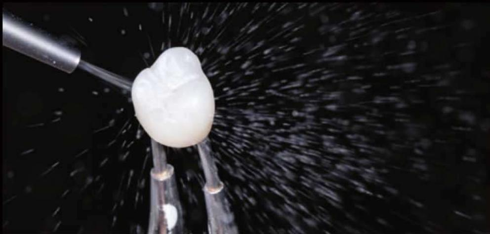
1. 洗浄と濡れ性向上の為に酸化アルミナでブラストします。
